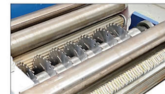
单轴多片 Многие дисковые пилы на одном шпинделе
