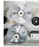
上下二轴结构，锯片薄 С верхней и нижней дисковой пилой, дисковая пила тонкая
