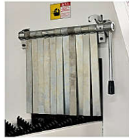
出料安全装置 Безопасная установка при выходе материала 专利号№ патента: ZL 2016201676641
