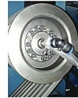
皮带轮涨紧装置 同轴度高 噪音低 水冷却装置 Установка натяжения шкива, одинаковая высота шпинделя и шум низкий, установка водяного охлаждения
