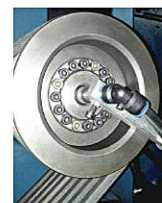
皮带轮涨紧装置 同轴度高 噪音低 水冷却装置
